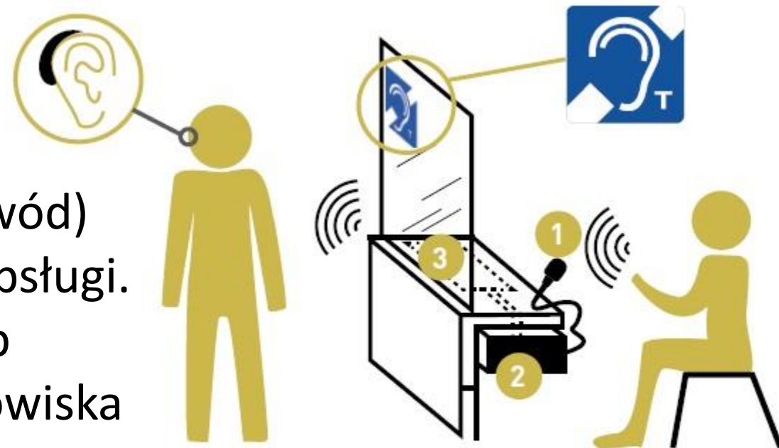
Rys. Schemat działania pętli indukcyjnej okienkowej
