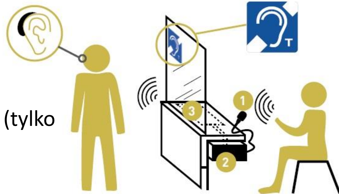
Rys. Schemat działania pętli indukcyjnej okienkowej
